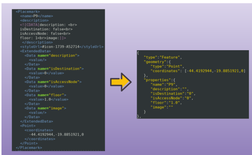
Figure 5. Um ponto arbitrário "P9" convertido de KML para GeoJSON.
